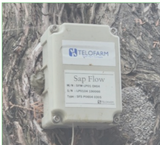
측백나무에 설치된 텔로팜의 수분 측정기.
